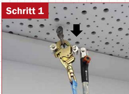
Spezialkonstruktion von oben über den Spezialkarabiner stülpen, wie in Schritt 1 + 2.
