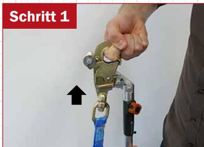
Spezialkarabiner von unten an die Spezialkonstruktion anlegen.
