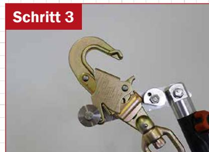
Ist der Spezialkarabiner korrekt arretiert, bleibt er automatisch offen.
