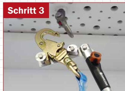
Spezialkarabinerhaken vom Anschlagpunkt entfernen.
