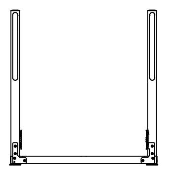
Pfostenrahmen mit zwei Endbügeln für Ende. Zwei weitere Endbügel für Start.
