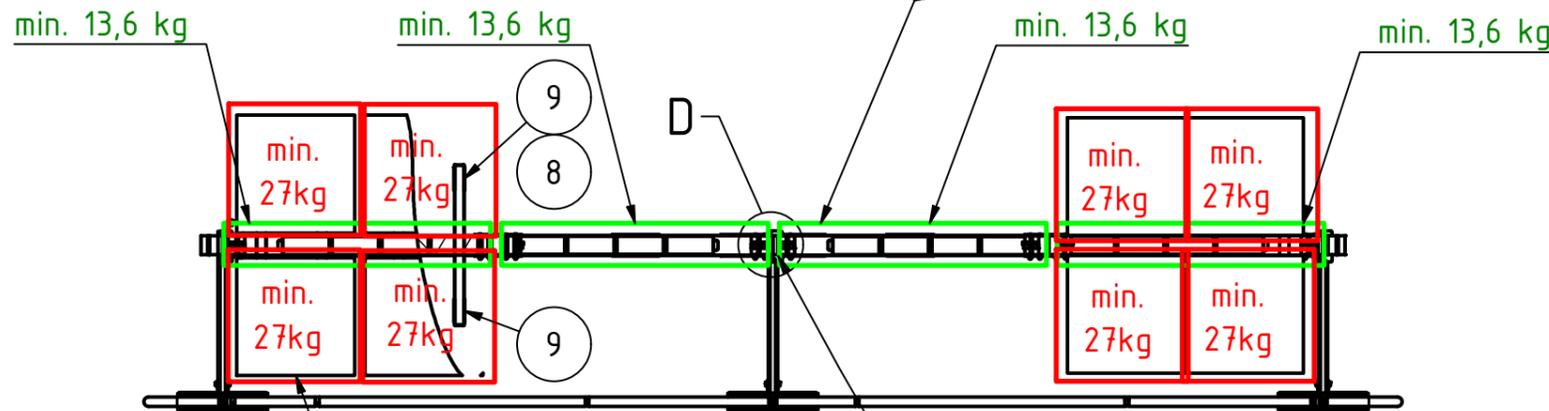
Diese zusätzlichen Gewichte sind ausschließlich an den Enden der PV-Anlage notwendig.
