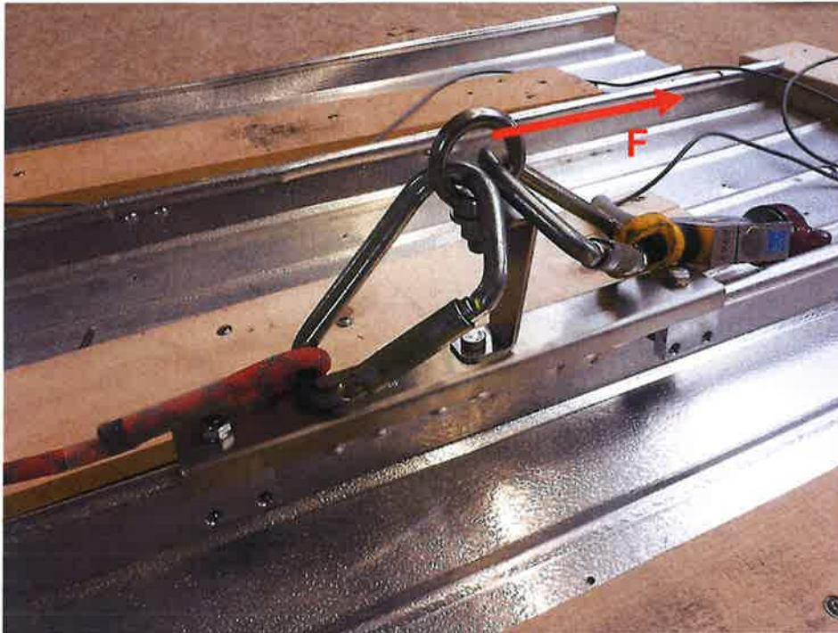
Prüfaufbau 3: Anschlageneinrichtung, Typ: ABS-Lock® Falz IV-ZW mit Erhöhung, montiert auf Rundbördeldach (Aluminium, t = 0,7 mm)
