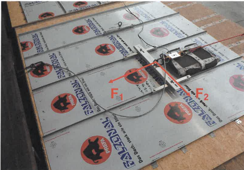
Bild 7: Prüfaufbau E: Anschlagereinrichtung Typ: ABS-Lock® Falz IV montiert auf Doppelstehfalzdach (Aluminium, t = 0,8 \text{ mm} ) mit Kräfteinwirkungsrichtungen F_1 und F_2 .
