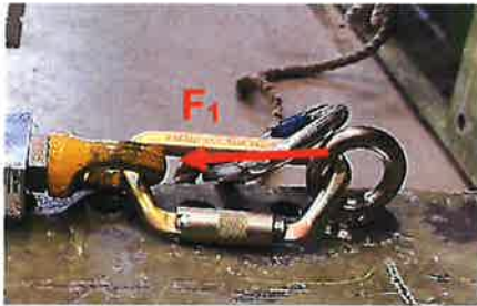
Prüfaufbauten 1 - 2: Montierte Anschlageneinrichtung mit Position und Richtung der Krafteinleitung
