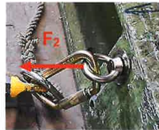
Prüfaufbauten 1 - 2: Montierte Anschlageneinrichtung mit Position und Richtung der Krafteinleitung
